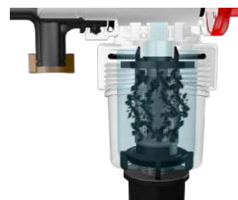
Siatka filtracyjna zatrzymuje cząsteczki magnetyczne o większych rozmiarach i niemagnetyczne
